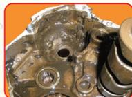
假冒/劣质机油没有添加剂或添加剂质量差，无法防止油泥生成，无法把发动机内表面上形成的“漆膜”和“积炭”洗涤下来。假冒/劣质机油油性、润滑性能等均很差，会造成发动机零件快速磨损，缩短发动机使用寿命！
